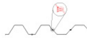
ESTACA DE JUNÇÃO ENTRE ESTACAS EU E ESTACAS LARSEN
