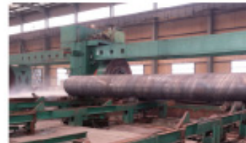
Instalações de teste de pressão hidráulica
